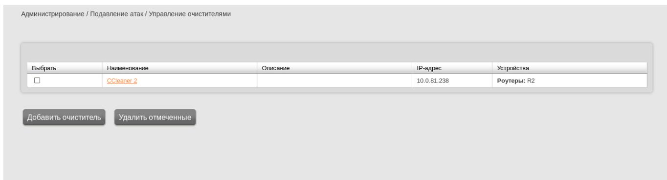
Рисунок 7 – Список подключенных «Очистителей» к текущему ПК «Анализатор»
